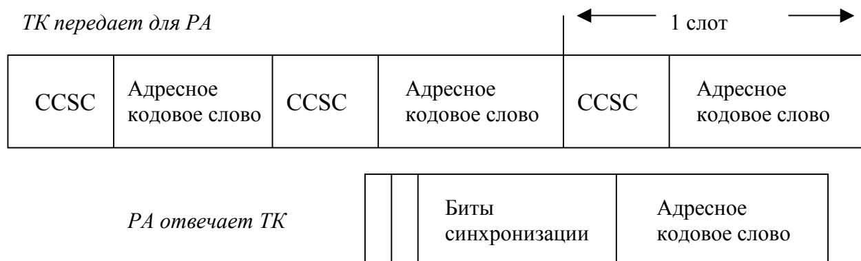
Рисунок 2.1 - Структура сигнализации на канале управления
